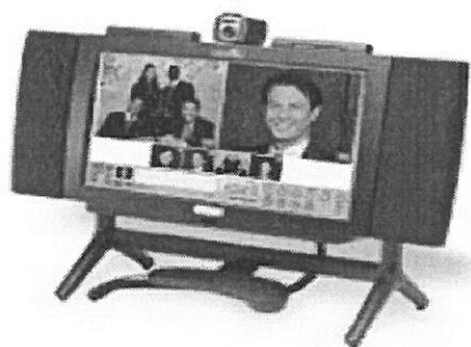
Сурет 2.7 - ViPr 4200 дербес (үстел) жүйесінің сыртқы түрі
