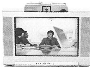
Сурет 2.3 - Кіріктірілген камера және Polycom V500 микрофоны бар бейне байланыстың портативті құрылғысы TV-мониторға қосылған
